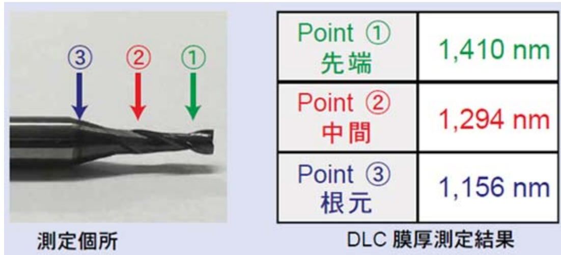
図 10 実サンプルの各部位での膜厚測定事例
