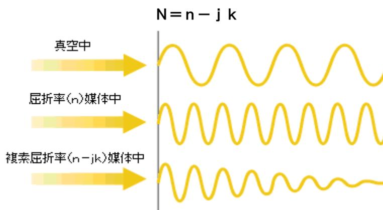
単純に膜厚だけを測定する場合、消衰係数はパラメータを増やし、解析を難しくするだけのため、一般的には測定光源に近赤外光を用いて、吸収のない波長で測定することが多くなります。液晶用カラーフィルターでは、着色は品質上における重要なファクターであるため、特に干渉による着色が加わり、表示デバイスの色調を変化させてしまうことさえあります。また、半導体分野では、結晶内部の電子状態の準位を示す重要な指標であるため、 $k$ の測定がますます重要になってきます。さらに、絶縁膜では着
