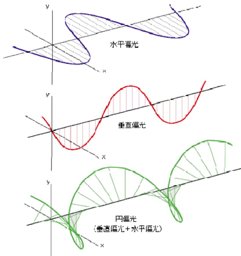
なぜ楕円偏光を解析すると膜厚が求められるのでしょうか？ P波とは反射面の法線に平行な偏光で、S波とは法線に直角な偏光成分の名称です。膜厚測定の場合には、分光エリプソ測定は、常に一定の入射角を持たせた反射測定で行います。P波とS波では表面での反射率が異なることに加え、反射率の比は光の干渉による効果が掛けられ、 $\tan$ になります。また薄膜の媒体中での光の進行速度の違いにより、位相差を生じます。これに加えて、反射時にP波とS波では位相の変化が異なるため、両者に位相差が生じます。従って、位相差も膜厚により変化します。これが分光エリプソ法による膜厚測定の原理です。
