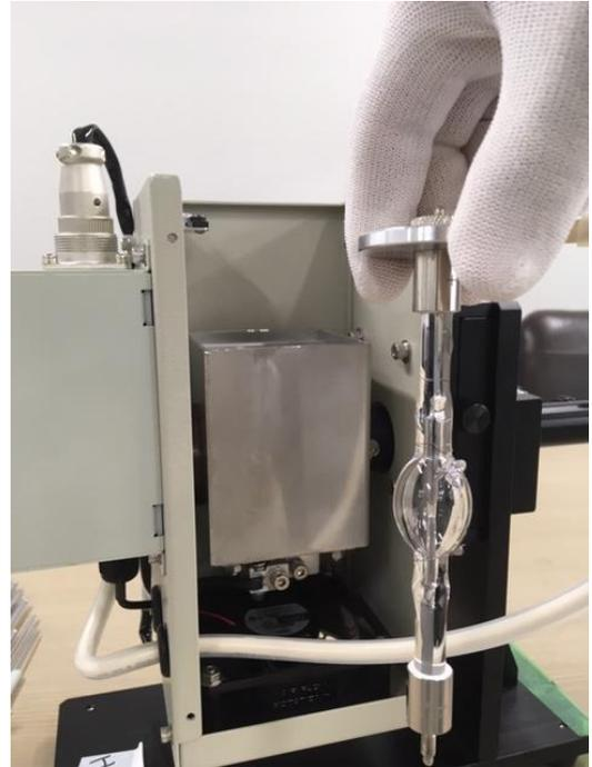
7. ランプを引き抜いたら、上部のランプ口金のローレット付き押さえ部品を外してください。その後、冷却フィン（アルミ製円板）を外してください。
