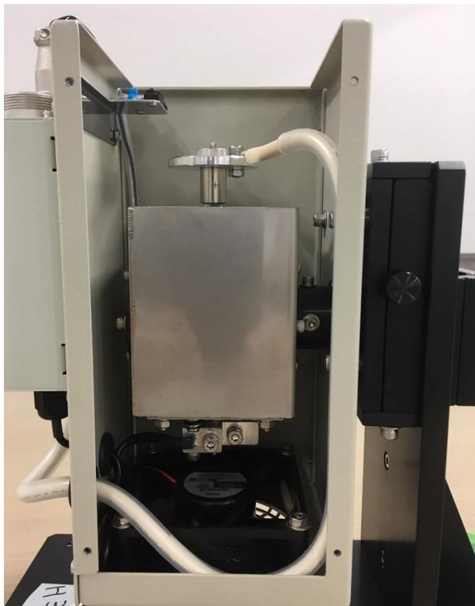
6. 上部の冷却フィン（アルミ製円板）部を持って、ランプに負荷をかけないようにゆっくりと垂直上方に引き抜いてください。
